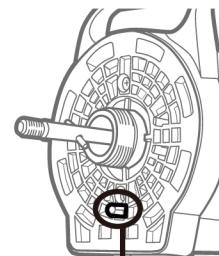
後ガードと取っ手前面の下の突起位置を合わせて後ガードをはめ込みます。
