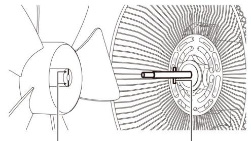
モーター軸のピンと羽根裏側中央の凹みを合わせて取り付けます。
